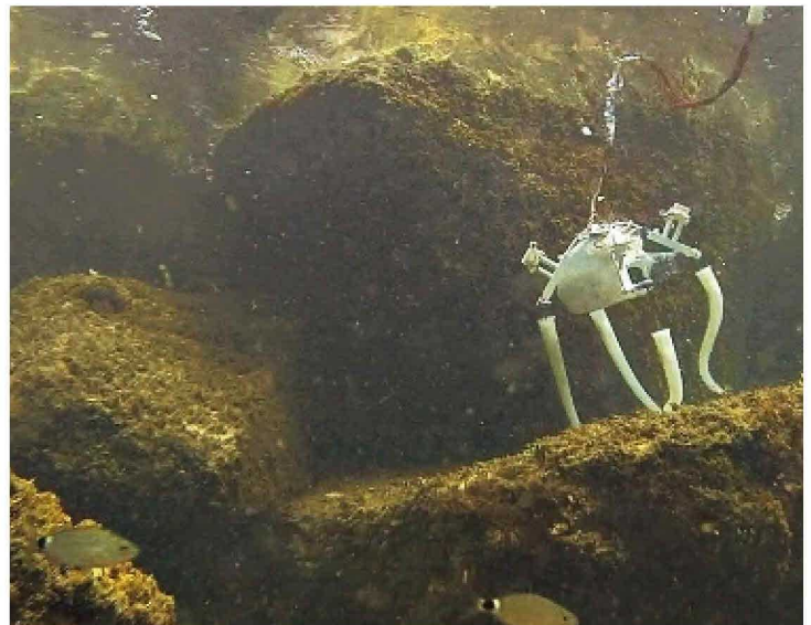
Il PoseiDrone, creato a Livorno e ispirato a seppie e polpi, è fatto all'80 per cento di gomma e silicone. È dotato di forza propulsiva, striscia, nuota e manipola oggetti. Può essere costruito in varie dimensioni.
